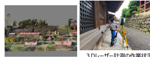
ドローンを使用したSfM写真測量 による3Dモデリングデータ
