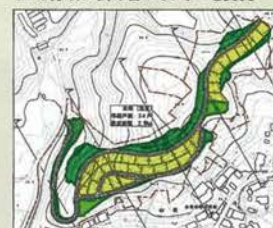
当初、直線の道路に沿って矩形の敷地が並び構成だったが、行政と交渉して自然な配置計画に変更した
